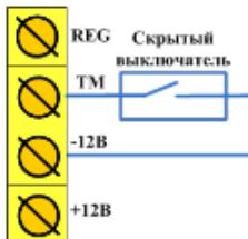
Рисунок 3.2 — Схема подключения скрытого выключателя
