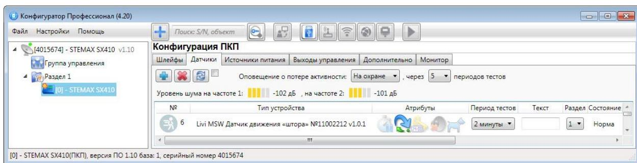
Рисунок 4.36 — Вкладка датчики (основные параметры работы радиоустройств)
