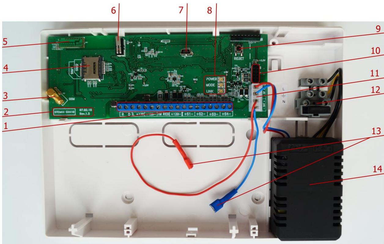
Рисунок А.1 — Вид контроллера со снятой крышкой
