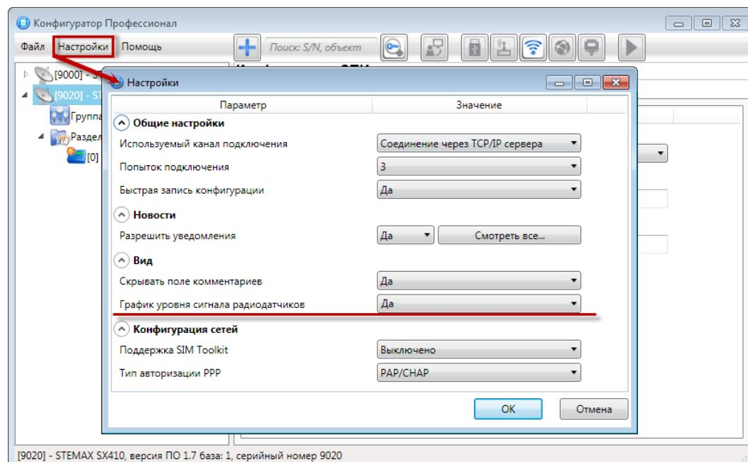
Рисунок 4.27 — Включение функции отображения графика уровня сигнала радиоустройств
