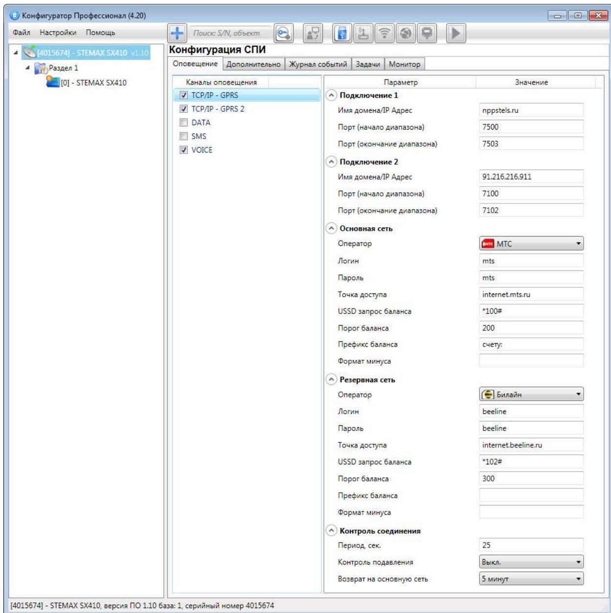
Рисунок 4.16 — Параметры канала TCP/IP – GPRS
