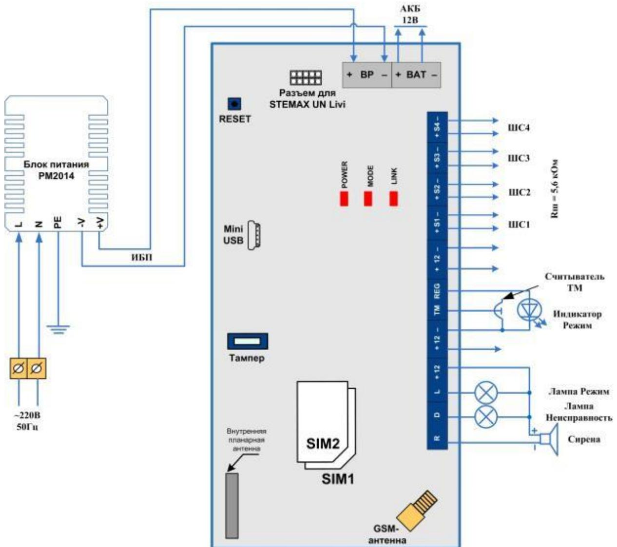
Рисунок A.2 — Схема внешних подключений контроллера
