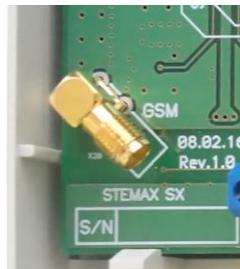
Рисунок 3.1 — SMA-разъем для подключения GSM-антенны
