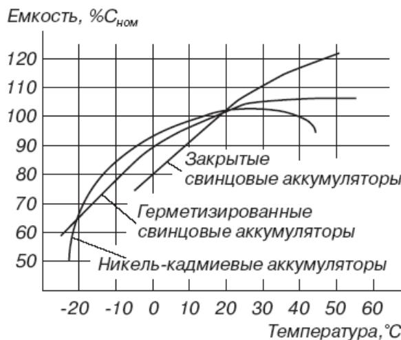
Рисунок 2.1 — Зависимость емкости АКБ от температуры
