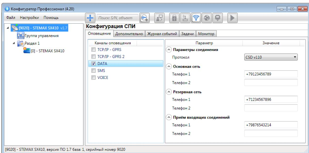
Рисунок 4.18 — Параметры канала DATA
