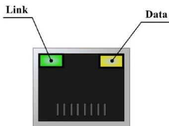
Рисунок 1.2 – Обозначение индикаторов Ethernet - разъёма
